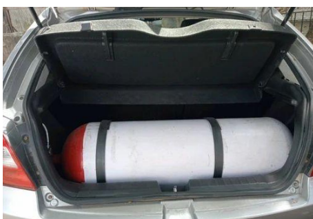
CNG-Tank im Kofferraum eines Autos
